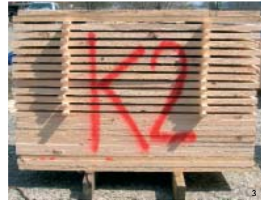
3 Versuchsstapelaufbau nach B-Methode mit insgesamt 110 zu bewertenden Brettern. Stapeldimension: ca. 0,5 m Breite, 0,7 m Höhe und 1 m Länge
