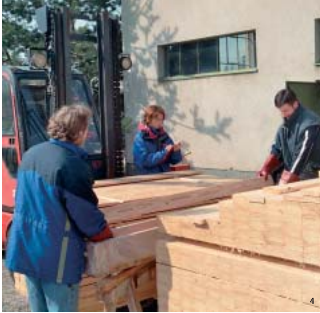
4 Frisch eingeschnittene Bretter werden in eine Tränklösung des zu prüfenden Bläueschutzmittels getaucht
