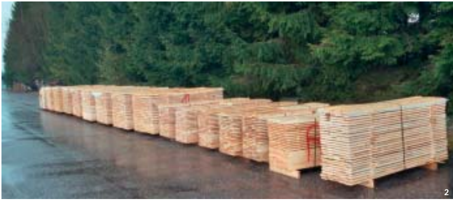
2 Prüfstapellagerung am Versuchsstandort. Links sind die HFA-Stapel gelagert, daran anschließend die B-Methode-Stapel, ganz rechts ist ein Stapel mit überzähligen Brettern
