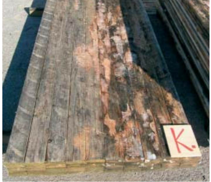
5 Verblauung einer dicht gelegten Brettreihe im unbehandelten Kontrollstapel nach 6 Monaten Versuchsdauer. Rechts sind 5 Kiefern Bretter, links 5 Fichtenbretter angeordnet. Deutlich sichtbar ist die sehr starke Verblauung sämtlicher Bretter sowie der starke Bewuchs der Kiefern Bretter mit holzerstörenden Pilzen
