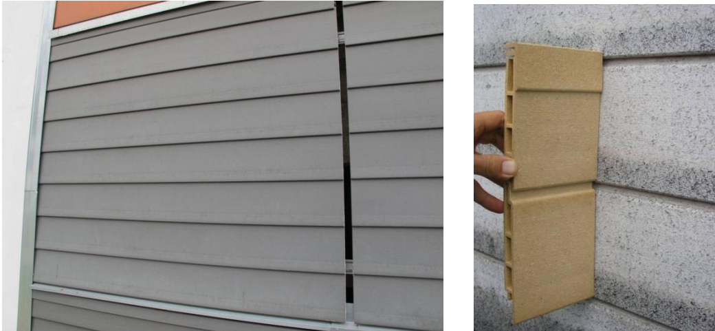
Abbildung 5: WPC-Deckings nach 8 Jahren Bewitterung (li mit Beschichtung, re Detail ohne Beschichtung)
